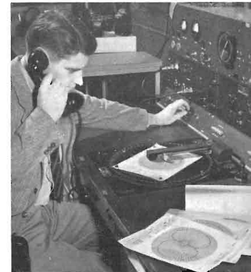
Il diagramma polare viene tracciato automaticamente mediante l'apparecchiatura visibile in figura. L'ing. Allen S. Dunbar è in contatto telefonico con il collega che si trova presso il pilone rotante.
