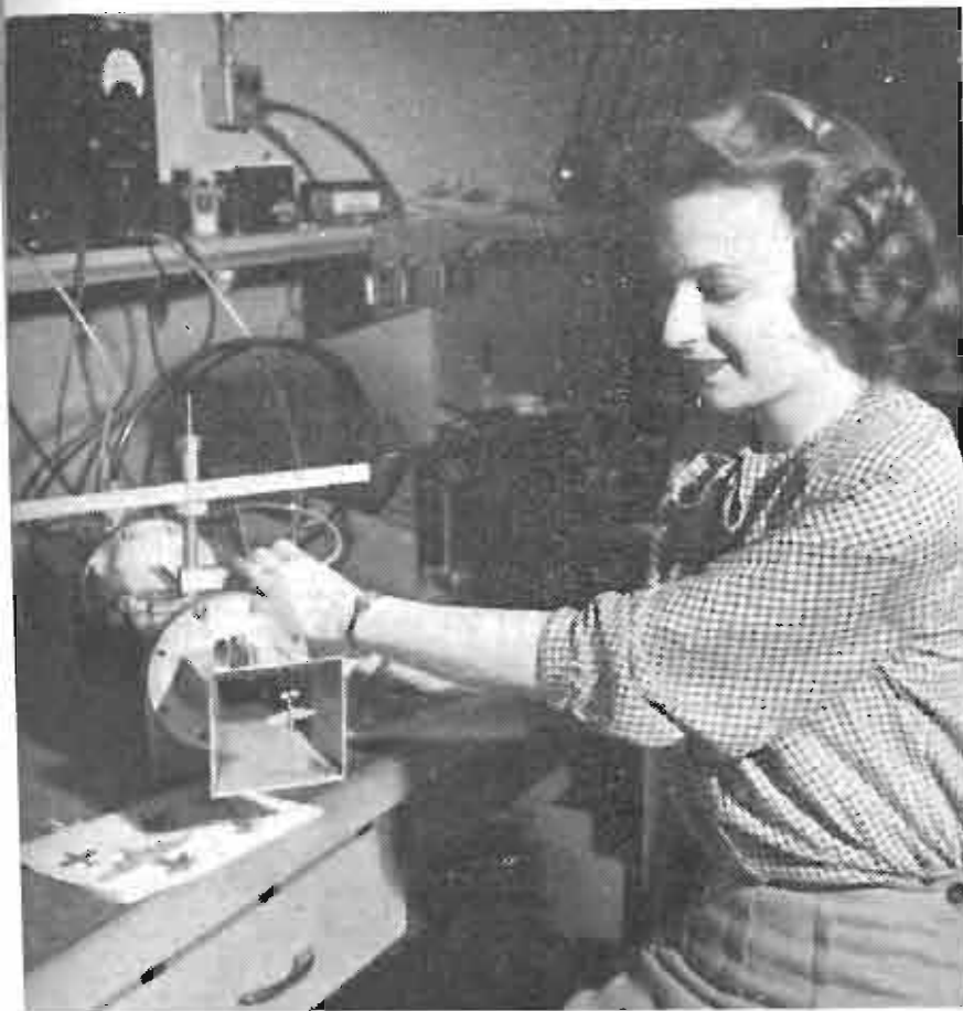
L'ing. Roberta F. Reese usa una guida d'onda rettangolare per determinare fenomeni di risonanza su modelli in scala di aeroplani.
