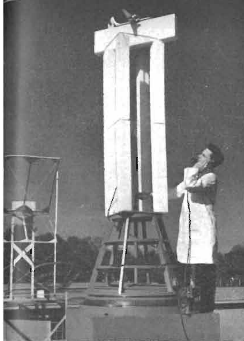
L'ing. Richard M. Hatch, Jr. sta ultimando la messa a punto del dispositivo per il tracciamento automatico del diagramma di irradiazione.
