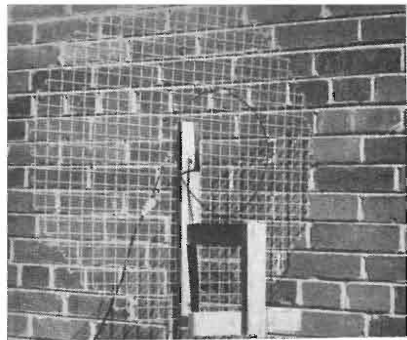
Antenna elicoidale ad una spira.
