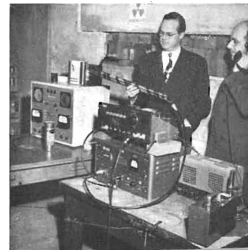
Fig. 2 - Dispositivo per eseguire la taratura della scala di un ponte di Wien.
